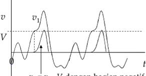
$v_R = v_1 - V$ , dengan bagian negatif ditiadakan oleh dioda
