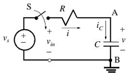
HTK setelah saklar tertutup:  $-v_s + iR + v = -v_s + RC \frac{dv}{dt} + v = 0$
