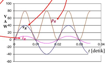
Bentuk gelombang arus sama dengan bentuk gelombang tegangan
