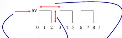
$V_p = 6 \text{ V} ; V_{pp} = 6 \text{ V} ; T = 3 \text{ s}$
