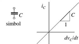
$$i_C = C \frac{dv_C}{dt} \Rightarrow v_C = v_C(t_0) + \frac{1}{C} \int_{t_0}^t i_C dt$$
