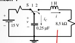
Saklar S telah lama berada pada posisi 1. Pada  $t = 0$  saklar dipindahkan ke posisi 2. Carilah perubahan tegangan kapasitor.
