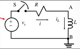
Dalam rangkaian listrik solusi homogen adalah tanggapan rangkaian apabila  $x(t) = v_s = 0$  dan tanggapan ini disebut **tanggapan alami**
