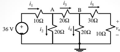
Misalkan  $v_o = 1 \text{ V} \rightarrow i_5 = \frac{v_o}{10} = 0,1 \text{ A} \rightarrow v_B = 0,1(30 + 10) = 4 \text{ V}$
