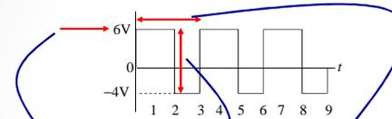
$V_p = 6 \text{ V} ; V_{pp} = 10 \text{ V} ; T = 3 \text{ s}$
