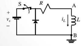
Sesaat sebelum saklar dibuka, arus pada induktor adalah  $i_L = v_s/R$ . Pada waktu saklar dibuka, arus induktor akan turun menuju nol dalam waktu tertentu karena arus induktor tidak dapat berubah secara mendadak. Sebelum mencapai nol arus induktor mengalir melalui dioda.
