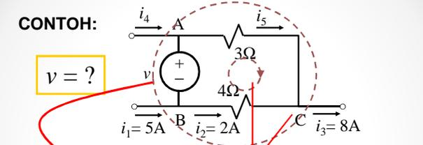
**simpul super ABC**  $i_4 + i_1 - i_3 = 0 \Rightarrow i_4 = i_3 - i_1 = 8 - 5 = 3 \text{ A}$
