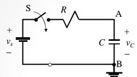
Apabila sesaat sebelum saklar S ditutup kapasitor tidak bertegangan, maka setelah saklar ditutup tegangan kapasitor akan meningkat mulai dari nol. Tegangan kapasitor tidak dapat berubah secara mendadak.
